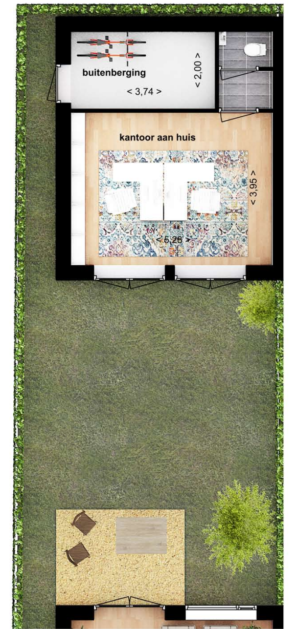
BOUWNUMMER 3 OPTIE Begane grond Schaal 1:100 In plaats van een kleine berging kantoor aan huis met toilet en grotere buitenberging (niet mogelijk in combinatie met verlengde woonkamer)
