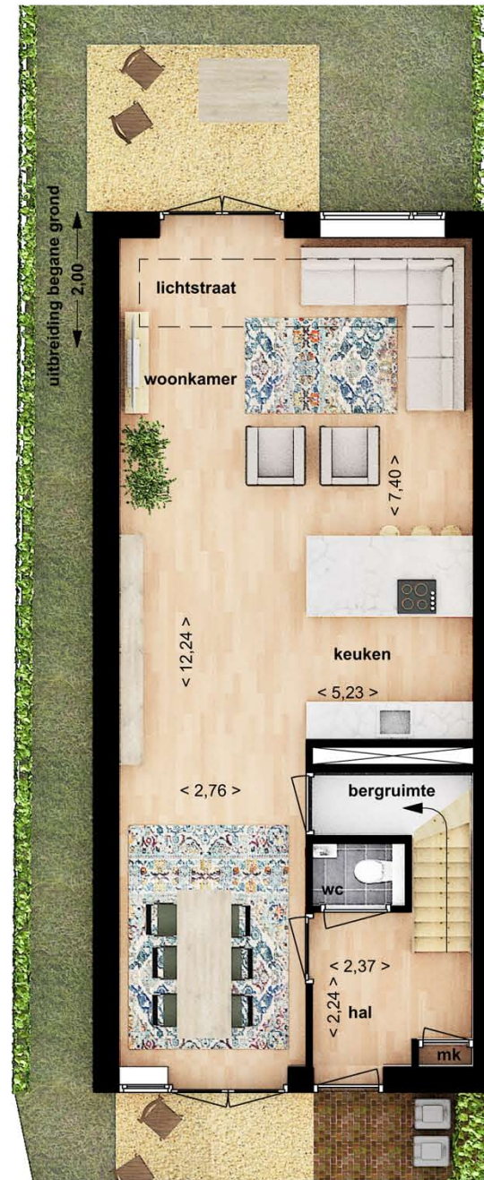
BOUWNUMMER 3 OPTIE Begane grond Schaal 1:100 uitbouw woonkamer 2 meter met lichtstraat (plat dak)
